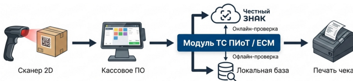
Рис. 3. Принцип работы ТС ПИоТ [4]
