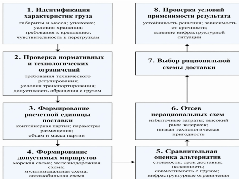
Рис. 3. Алгоритм выбора рациональной схемы доставки технологического оборудования (составлено авторами)
