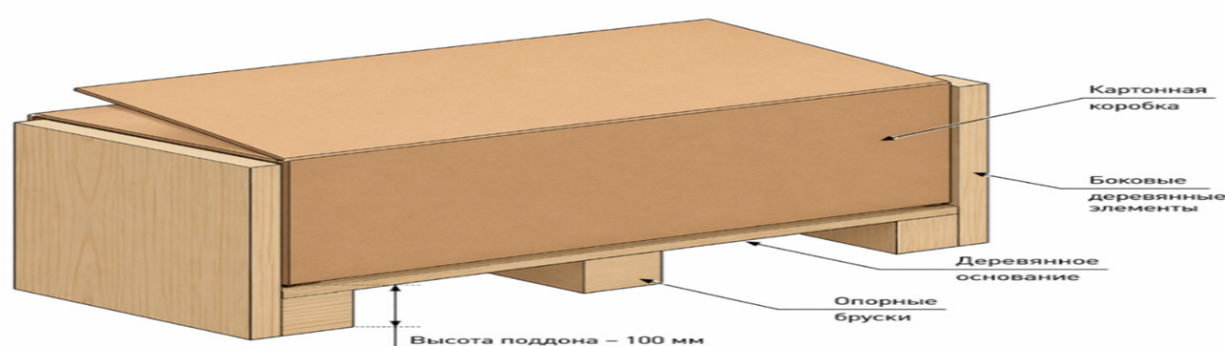
Рис. 2. Транспортная упаковка насосного агрегата
