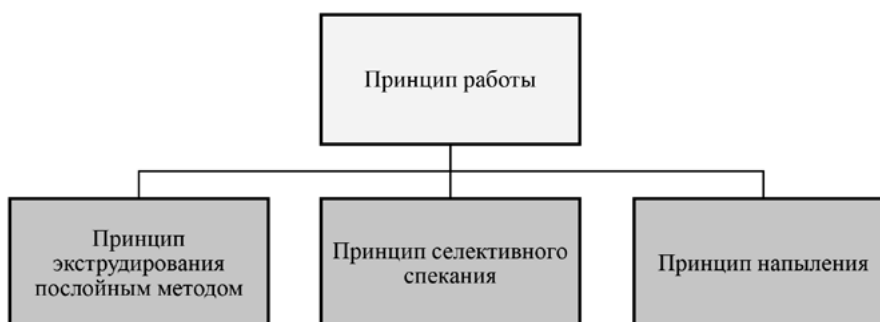
Рис. 2. Принципы работы 3D-принтера
